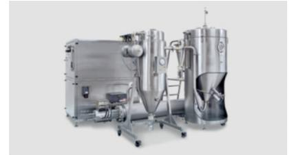
Eine exakte Strömungsführung der heißen Trocknergase ist der Schlüssel zur Minimierung von Pulverablagerungen.
