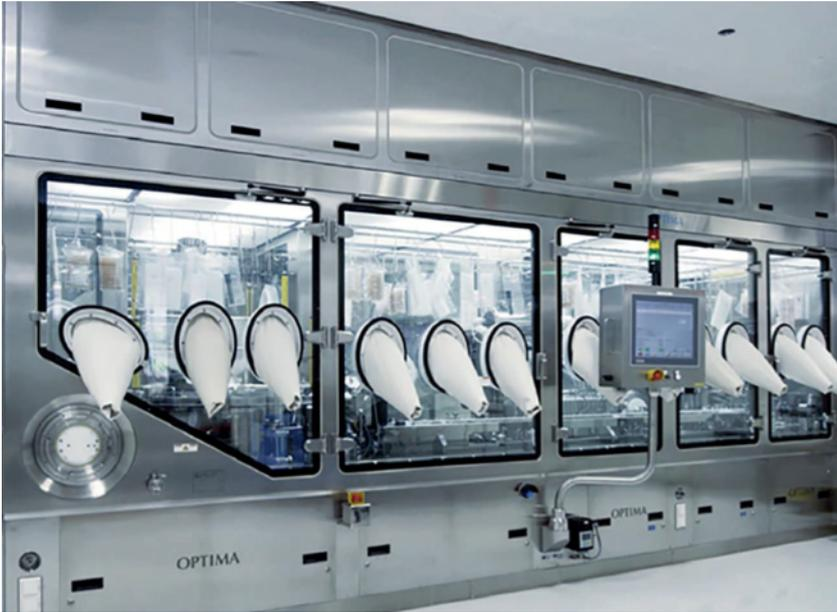
Abbildung 2: Isolator zur Abfüllung aseptischer Produkte (Quelle: Optima).
