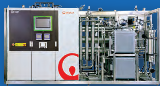
Orion™: Enthärtung, Umkehrosmose und kontinuierliche Elektrodeionisation in einem System
